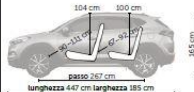
larghezza interna: ant. 151 cm, post. 150 cm bagagliaio: 513-1503 litri pneumatici: 225/60 R17, min. 215/70 R16
